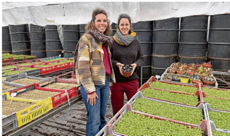
Amélie Himpens et Marie Moyet dans la serre bioclimatique à Aubagne qui a capté l'énergie du soleil pour la restituer la nuit lorsqu'il fait plus froid. Les bidons noirs remplis d'eau servent de masse thermique. /PHOTO GVL
